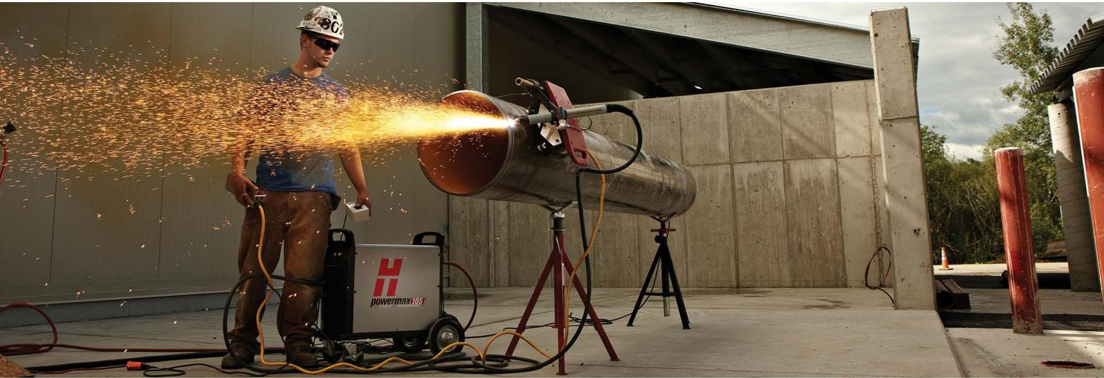
Plasma aus Druckluft entsteht durch die elektrische Aufladung von Gas und kann Metalle mit einer Stärke von bis zu 57 mm schneiden. Powermax®-Geräte sind bedienerfreundlich und tragbar und weisen höhere Schnittgeschwindigkeiten auf als Autogen.
